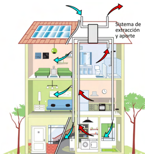
Figura 28: Ventilación mecánica con recuperación de calor
