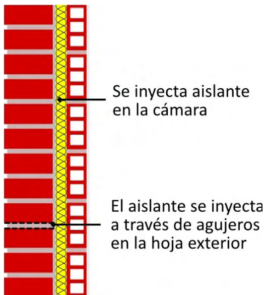
Figura 9: Aislante inyectado en una cámara de aire
